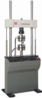
Mašina za test zatezanja sa automatskim beleženjem izmerenih podataka
