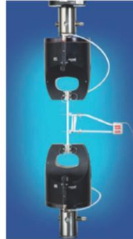
Tipična čelična epruveta sa ekstenzometrom koji meri izduženje
