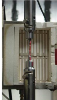
Eksperiment zatezanja čelične epruvete
